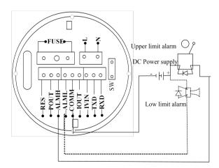
Fig 4.4.2(d) Connection of Alarm Output
